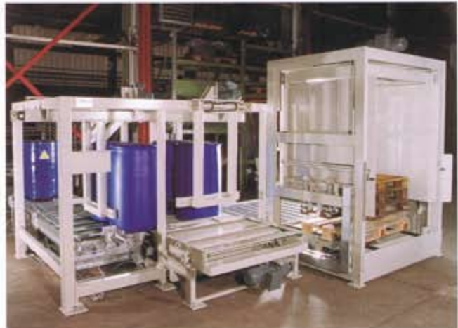
Die Palettier-Anlage umschließt sanft die Fässer. Beschädigungen durch Herunterfallen oder Verbeulen durch seitliches Greifen werden sicher verhindert.
