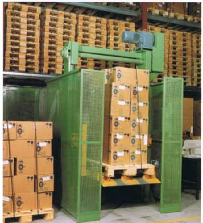
Ausfördern auf hintere Fördertechnik
