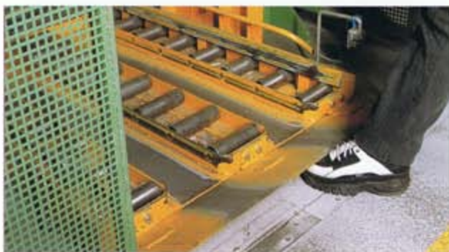
Sicherer Schutz durch seitliche Gitter und Scharnierplatte
